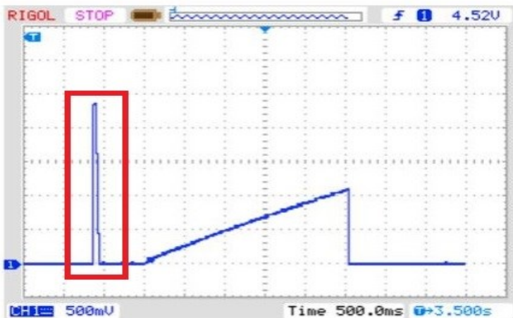
Рисунок 1 – Процес виміру параметрів конденсатора з номіналом 22 пФ
