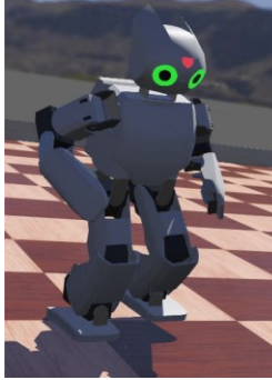
Рисунок 1 – Зовнішній вигляд та наведення прикладу кроку гуманоїдної робототехнічної платформи Robotis OP2
