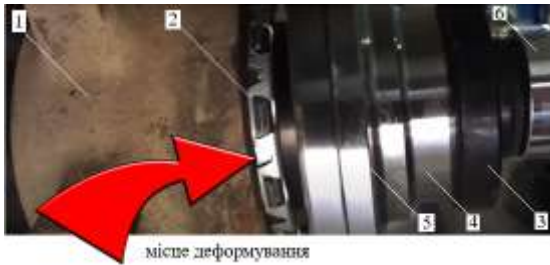
Рисунок 1 – Процес установки підшипника маточини колеса:
